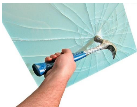
Figura 3 - Vidro Laminado Quebrado
